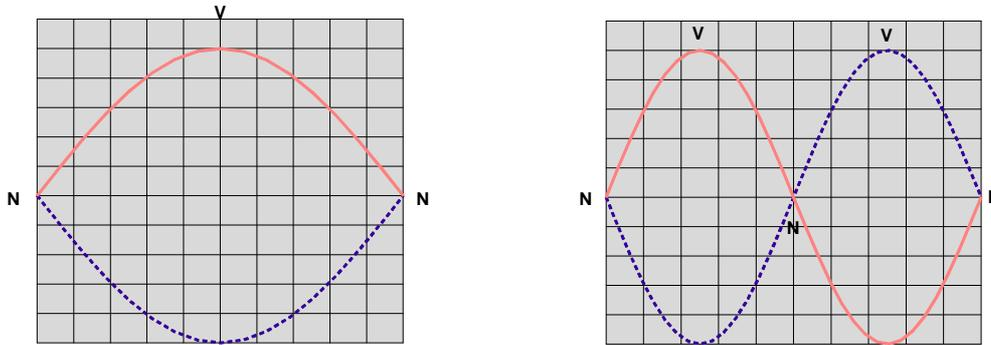
[b2] La velocidad de propagación es igual al producto de la longitud de onda por la frecuencia, esto es;  $v = \lambda \cdot f = 1,30 \cdot 220 = 286 \text{ m/s}$ .
